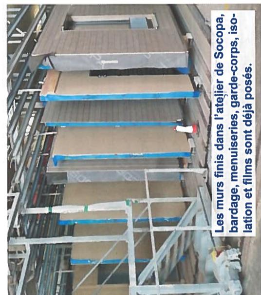
Les murs finis dans l'atelier de Socopa, bardage, menuiseries, garde-corps, isolation et films sont déjà posés.
